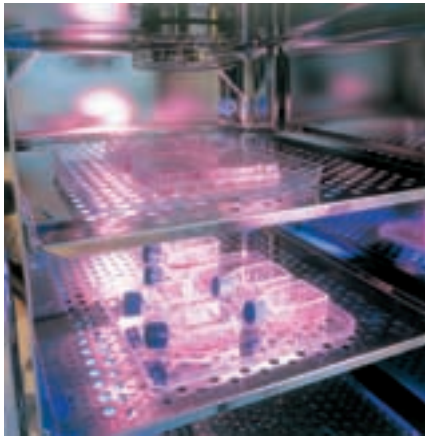
Ryc. 30.2. Inkubator do hodowli komórkowych – temperatura 37°C, 5%CO 2
