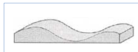
Ryc. 3 Filtrowany profil falistości (W). Filtered waviness profile (W).
