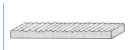
Ryc. 2 Filtrowany profil chropowatości (R). Filtered roughness profile (R).
