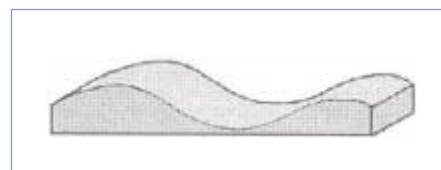
Ryc. 1 Niefiltrowany profil pierwotny (P). An filtered origin profile (P).
